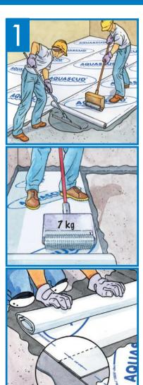
Applicare con apposito frattone dentato o tiramalta Volteco un primo abbondante strato di miscela AQUASCUD® in modo da garantire uno spessore minimo di 1÷1,5 mm, facendo in modo che la miscela penetri bene nel sottofondo e copra completamente la superficie.
